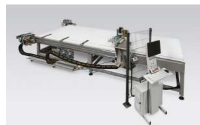
Banco automatico per l'avvitamento della ferramenta Schüco FSA-100
